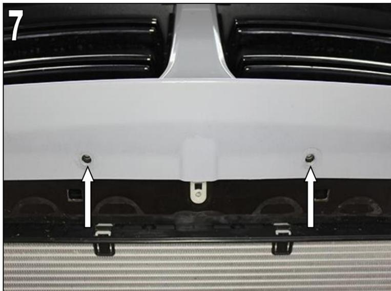
Vissez la plaque de montage AC Schnitzer avec les deux vis de fixation standard.
